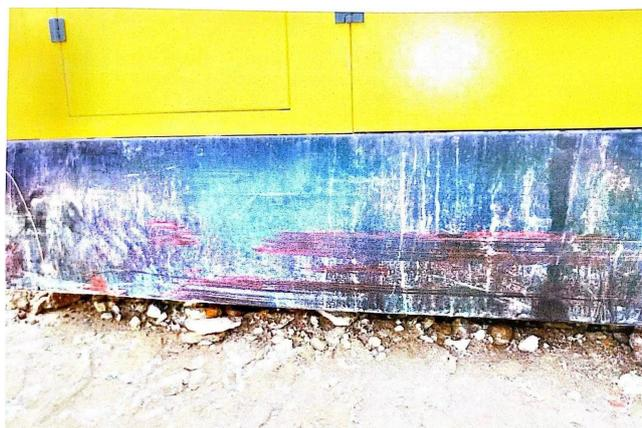
照片5 空压机右侧底部擦蹭痕迹照片
